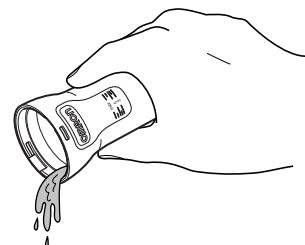
5. Вымойте все составные части небулайзерной камеры в теплой воде с использованием мягкого моющего средства, после чего промойте под струей горячей воды, или вымойте их в посудомоечной машине.
